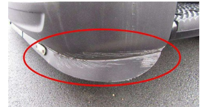
Materialabtrag oder Verformung möglich oder wirtschaftlich reparierbar
