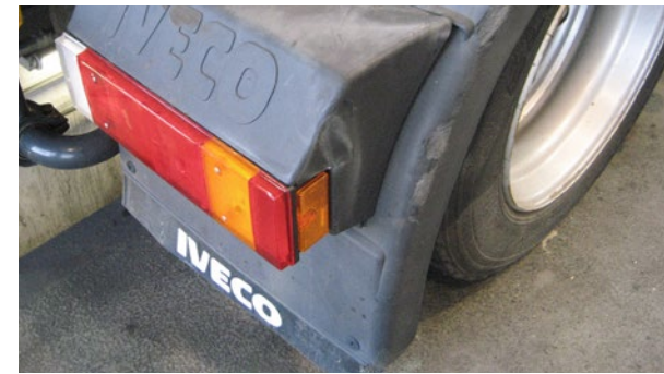
Tiefe Kratzer und Verformungen
