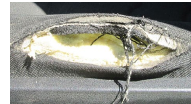
Schaumstoff fehlt oder gebrochener Rahmen
