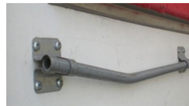
🔧 Polsterung und Stangen: Stangen und Polster verformt, können auf wirtschaftliche Weise repariert werden
