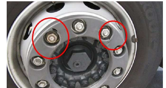
Radabdeckungen: Verformt, gebrochen, Material fehlt oder entfernt
