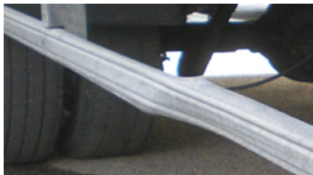
Seitenunterfahrerschutz: Deformationen, die nicht auf wirtschaftliche Weise repariert werden können
