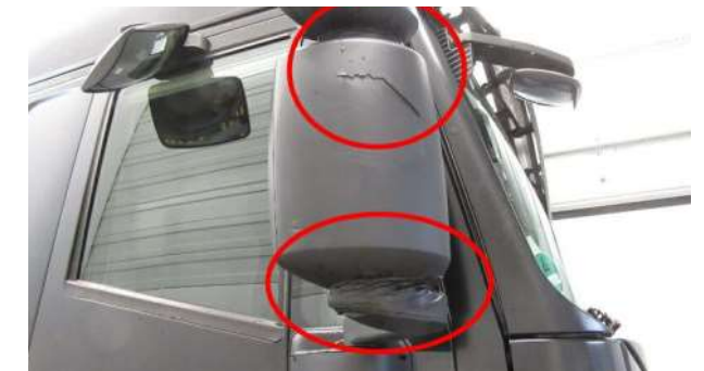
Materialabtrag oder Verformung möglich oder wirtschaftlich reparierbar
