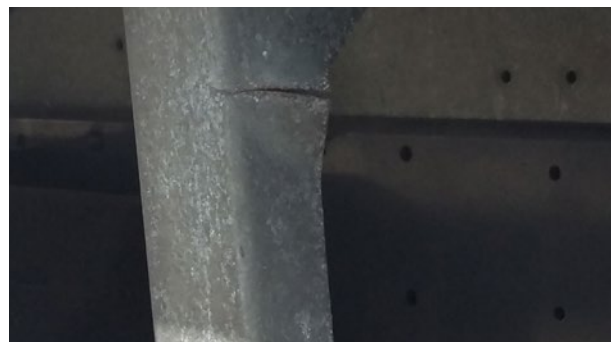
Seitenunterfahrerschutz: Deformationen, die nicht auf wirtschaftliche Weise repariert werden können
